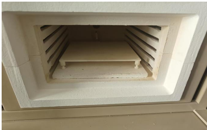
图 9 放入马弗炉中的可调节平板的实物照片
