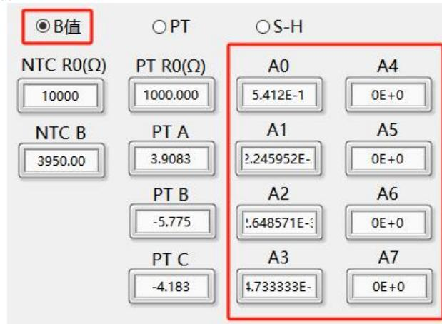
通过电脑软件写入  $A_0 \sim A_7$  的值，如上图所示，即多项式温度修正完成。
