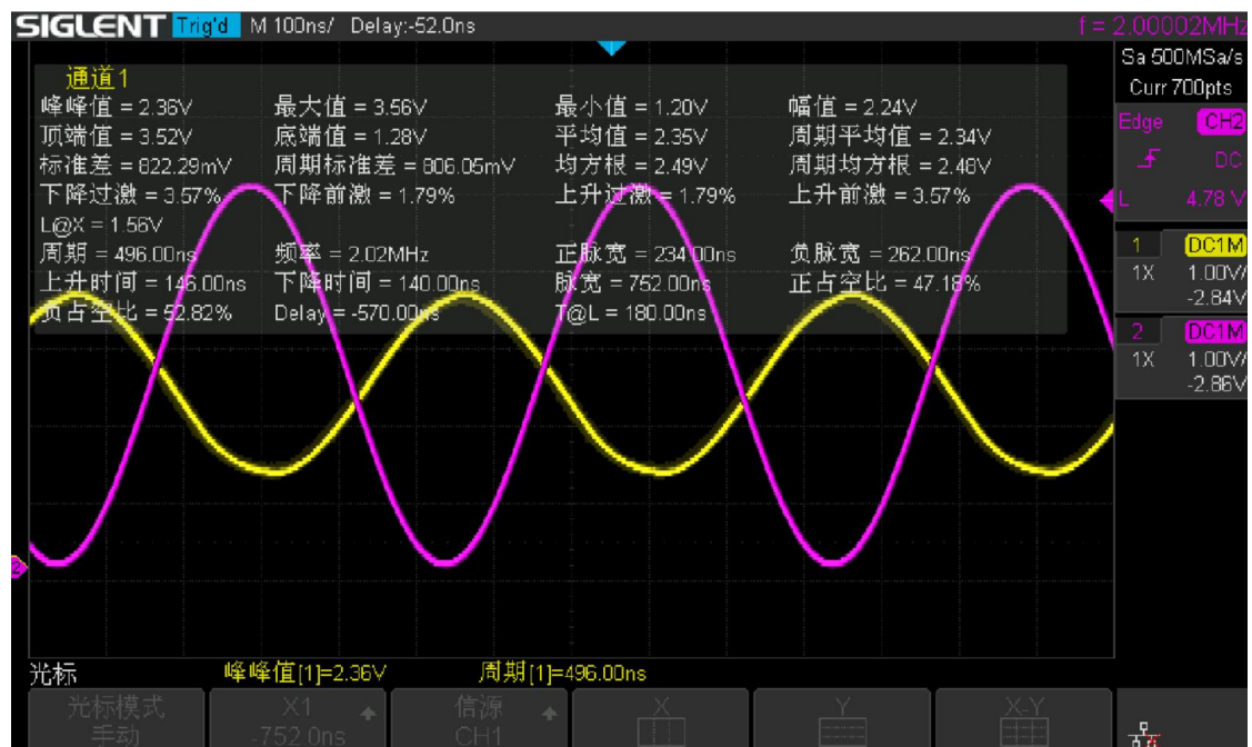
调制带宽测试图 (紫: 0~5V 的 2MHz 正弦信号输入, 10 欧姆负载测试; 黄色: 实际电流下降 3dB 后的曲线)
