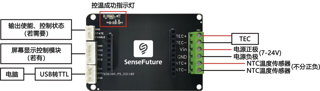
TEC103/TEC103L 转接板接线图
