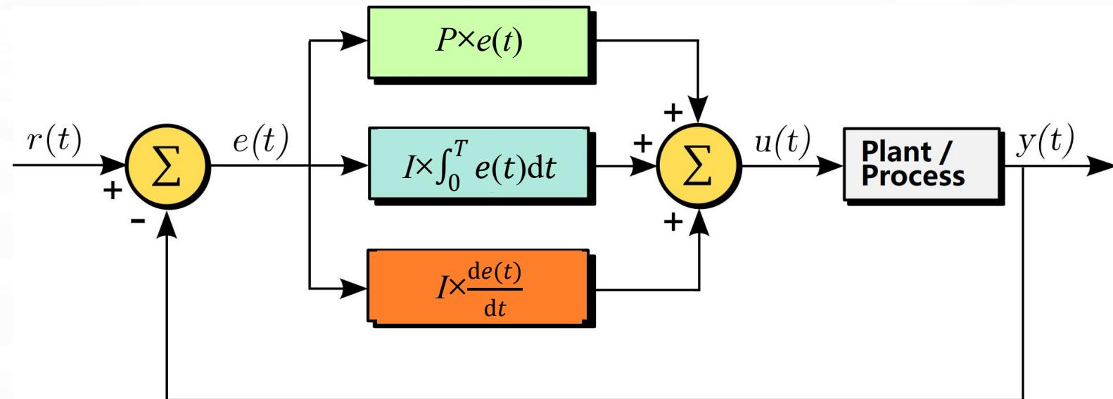
PID控制器是一种常见的负反馈控制算法，广泛应用于工业、仪器和日常生活中。它通过误差值（即期望设定值（SP）与测量值（PV）之间的差值）计算输出信号大小。PID控制器输出信号包括三部分：误差值比例输出部分、积分输出部分和微分输出部分三项，分别对应比例系数 $P$ 、积分系数 $I$ 和微分系数 $D$ 。
