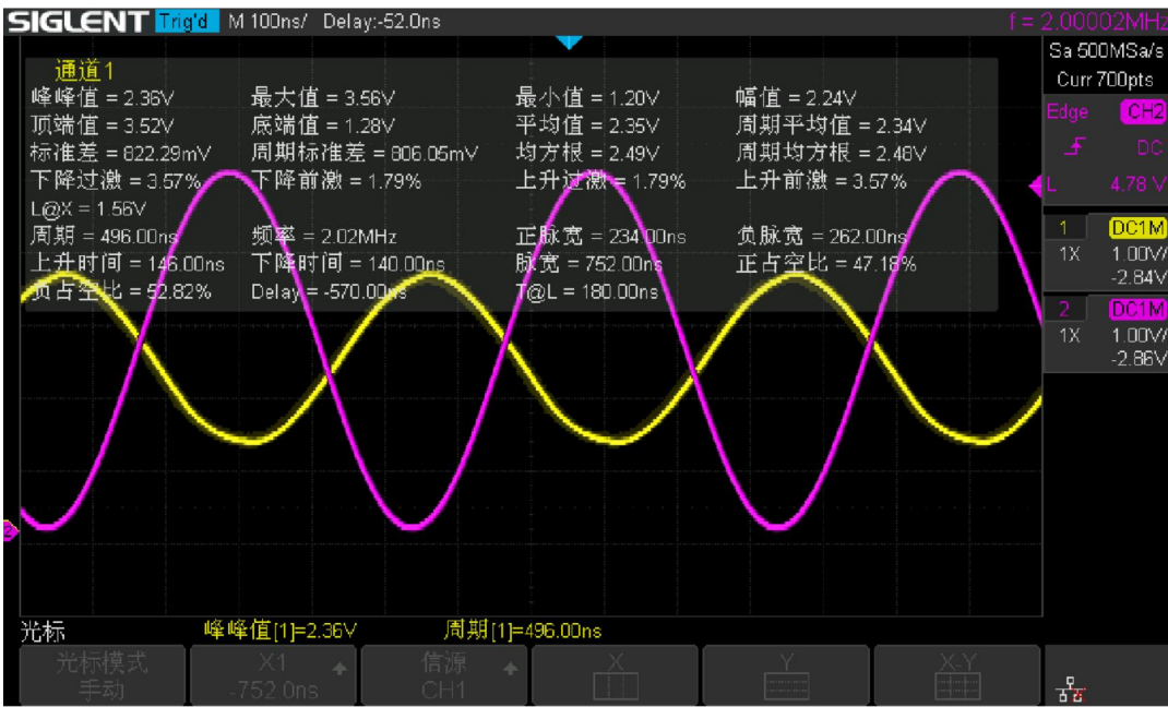
图 9 调制带宽测试图 (紫：0~5V 的 2MHz 正弦信号输入，10 欧姆负载测试；黄色：实际电流下降 3dB 后的曲线)
